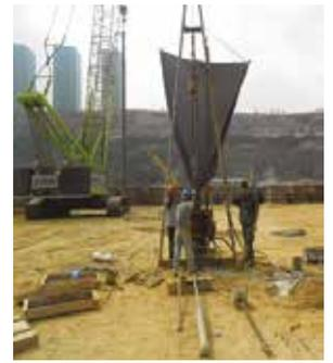
Figure 3 : Planche d'essai –schéma du maillage et photo de l'essai SPT
